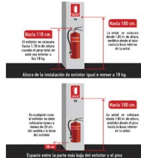
Figura N° 31: Ubicación de extintores igual o menor a 18 kg. Fuente: Recuperado de http://www.extinsafe.com
