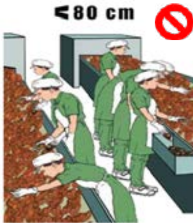
Figura N° 2: Espacio entre trabajadores. Fuente: Instituto Nacional de Seguridad e Higiene en el Trabajo. Recuperado de http://www.insht.es
