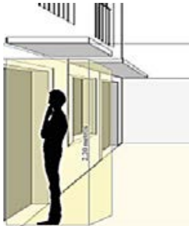
Figura N° 3: Altura libre de peatón. Fuente: Pinargote, A. (2015) Elaboración propia.
