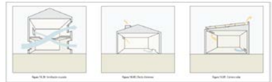
Figura N° 34: Sistemas generadores de movimiento de aire
