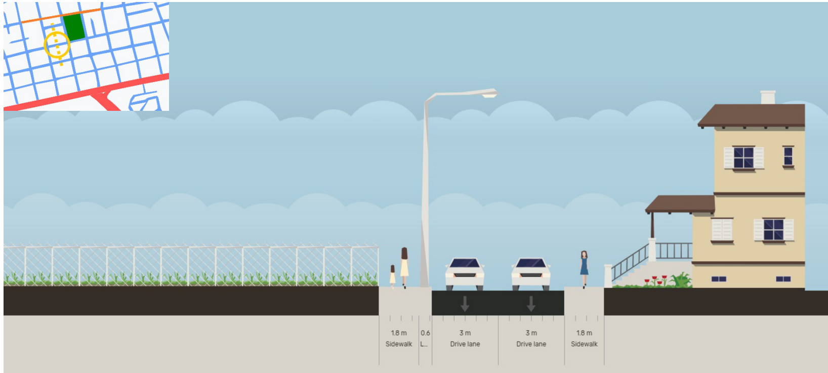
Imagen 93 Corte de las vías secundarias.
