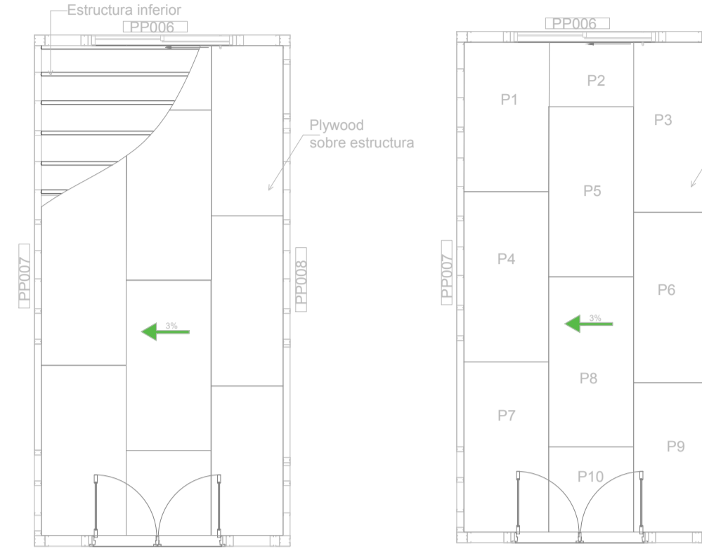
Recubrimiento de Cubierta PASO 2: PLYWOOD
