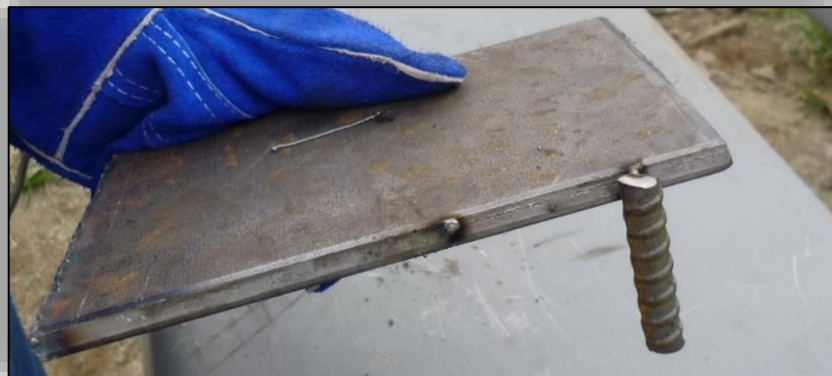
Ilustración 35: Varilla de 12mm soldada a fleje auxiliar
