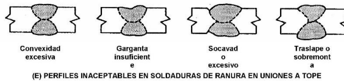
Ilustración 4: Perfiles de soldadura Aceptables e Inaceptables
