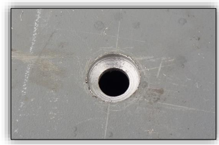
Ilustración 34: Avellanado en perforación.
