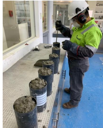
8. Luego de proporcionar los 15 golpes con el mazo de goma se procede a utilizar la placa de enrase para darle un acabado liso a la superficie realizando movimientos de acerrado a donde se ubique el técnico.
