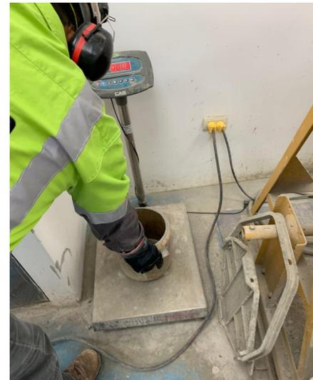
2. Previo a llenar el recipiente de ensayo con la mezcla de hormigón se deben humedecer todos los instrumentos que vayan a ser usados para realizar el ensayo, esto con el fin de no restarle humedad a la mezcla por el nivel de absorción que poseen los instrumentos.
