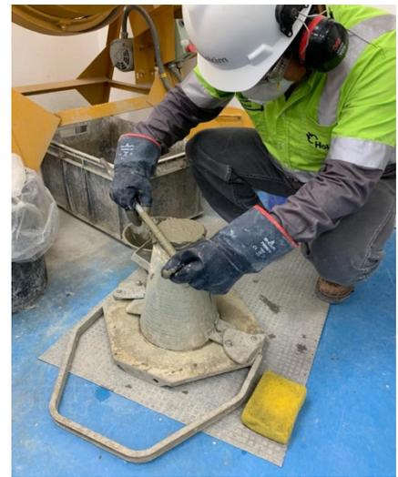
7. Una vez limpio se procede a levantar el cono en forma vertical, se deja que el hormigón se escurra.
