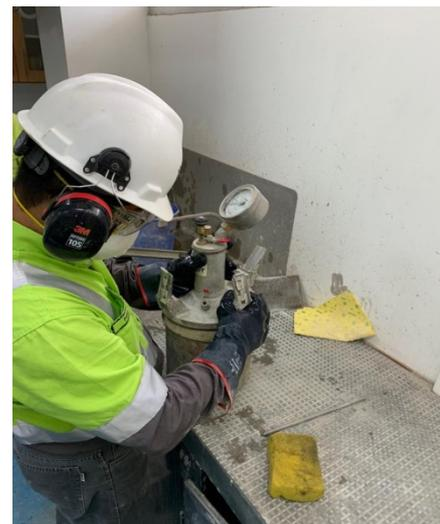
13. Ingresar agua por una de las válvulas de purga de agua con la finalidad de llenar la cavidad que queda sobre el hormigón y bajo la tapa.
