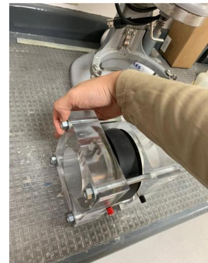
9. Insertar las soluciones en las celdas, hidróxido de sodio del lado izquierdo (rojo) y cloruro de sodio del lado derecho (negro).
