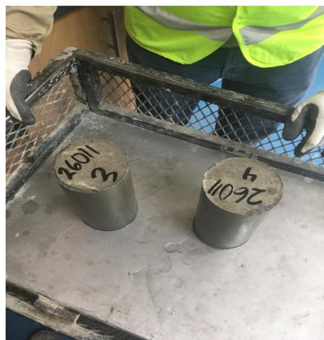
4. Una vez dentro del cuarto se procede a utilizar los equipos necesarios para poder colocar los cilindros dentro de la piscina de curado la cual posee agua a temperatura de 23C°.
