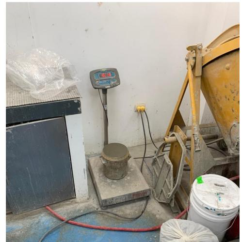
12. Restar el peso del recipiente de ensayo con hormigón del recipiente vacío para determinar el peso neto del hormigón.
