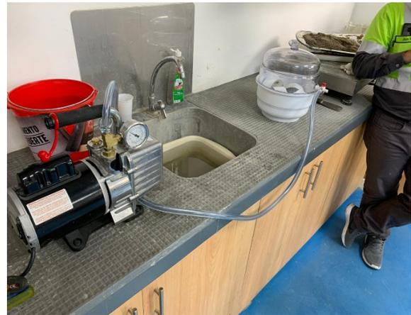
5. En una cubeta metálica calentar 5 lt de agua potable con el fin de eliminar el oxígeno que posee en el interior. Enfriar la olla hasta que la temperatura del agua sea de 23C°. Conectar una manguera a la válvula de la olla e introducir un extremo de la manguera dentro de la cubeta con agua. Apagar la bomba de succión.
