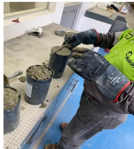
9. Limpiar completamente el exterior del recipiente de ensayo.
