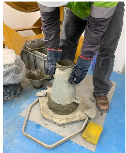
8. Por último, se coloca el cono de forma invertida a lado del hormigón y se procede a medir el asentamiento, el cual es la diferencia de alturas entre el hormigón y el cono.
