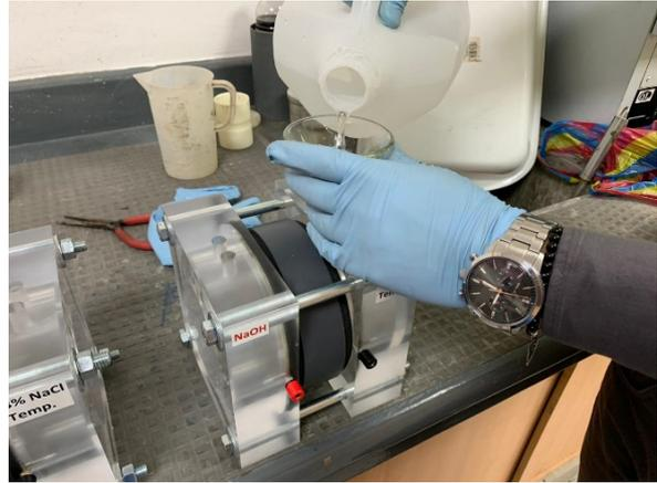
10. Colocar las celdas acrílicas en el lugar donde se correrá el ensayo y sobre un papel absorbente por motivos de seguridad.
