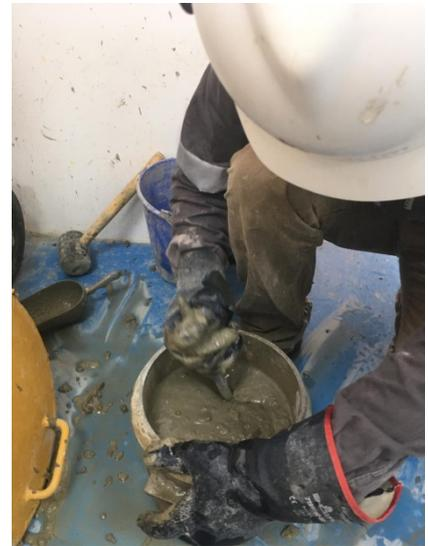
5. Impartir 15 golpes en la parte exterior del recipiente de ensayo utilizando el mazo de goma, esto con el fin de cerrar los huecos dejados por el proceso de varillado descrito en el paso anterior
