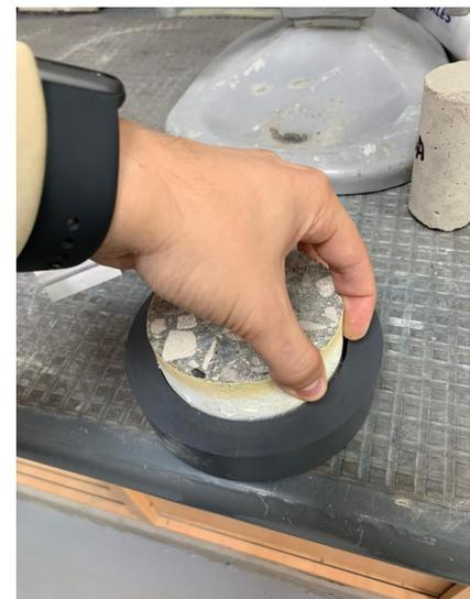
5. Recubrir usando las arandelas de goma los extremos sobresalientes de la probeta de hormigón.
