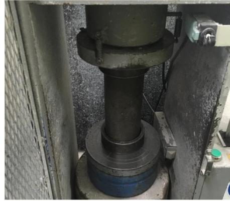
8. Lentamente empezar a desplazar el brazo de la prensa hasta que este esté en contacto con el cilindro.
