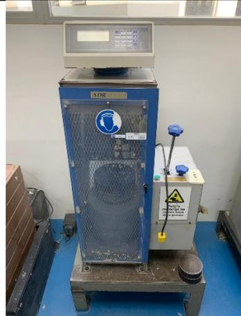
**Figura 2.14** Prensa hidráulica
