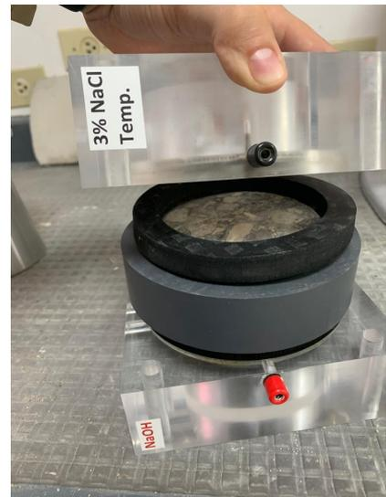
8. Ensamblar las celdas acrílicas con la probeta de hormigón en su interior.
