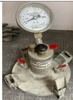
**Figura 2.7** Medidor tipo B
