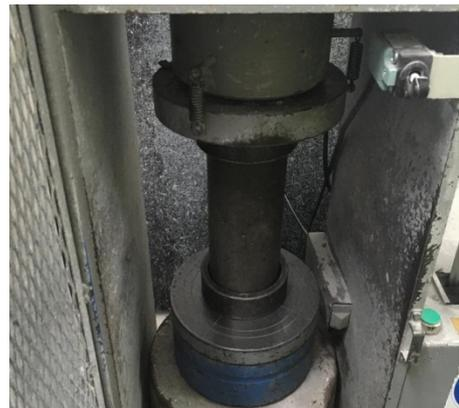
7. Verificar que el cilindro se encuentre centrado y en correcta posición según lo indican las marcas situadas en la base de la prensa
