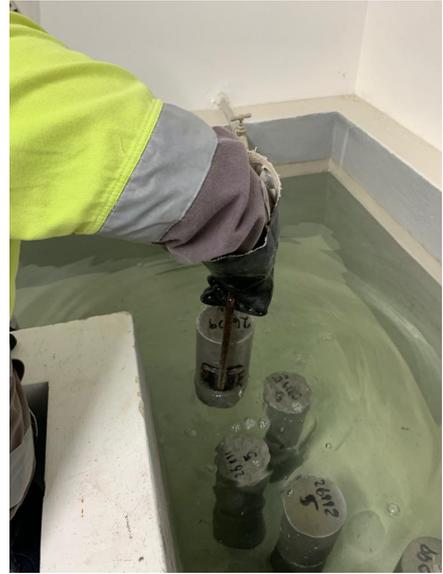
2. Trasladar los cilindros hermanos al laboratorio en el cual se encuentra la prensa hidráulica.
