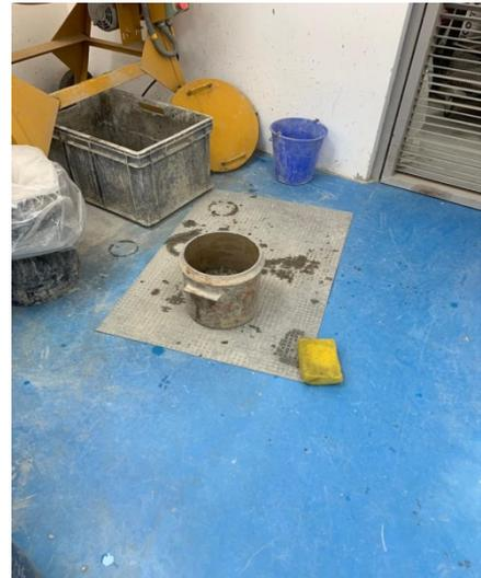
3. La superficie en la que se vaya a realizar el ensayo debe de estar nivelado y no debe presentar ningún tipo de vibraciones para no alterar el ensayo.
