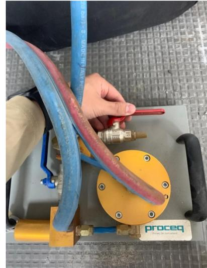
15. Abrir la válvula de color azul situada en el tablero de válvulas.
