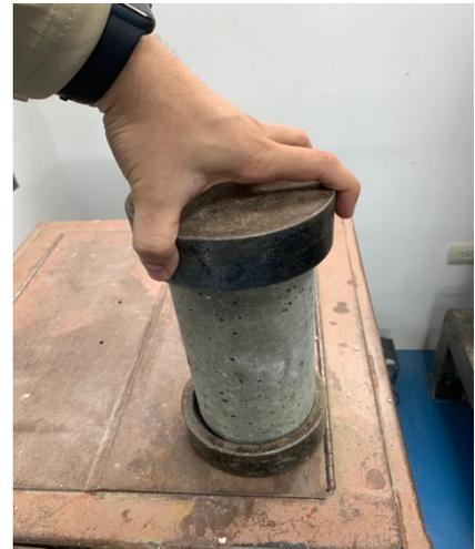
6. Colocar el cilindro dentro de la prensa.
