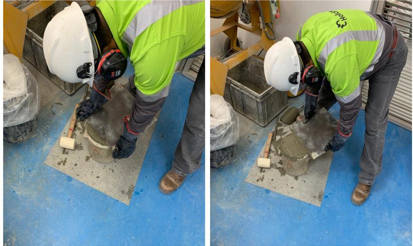
10. Limpiar completamente el exterior del recipiente de ensayo.
