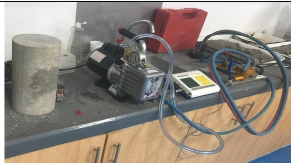
**Figura 2.17** Equipo de Torrent y bomba al vacío calibrados
