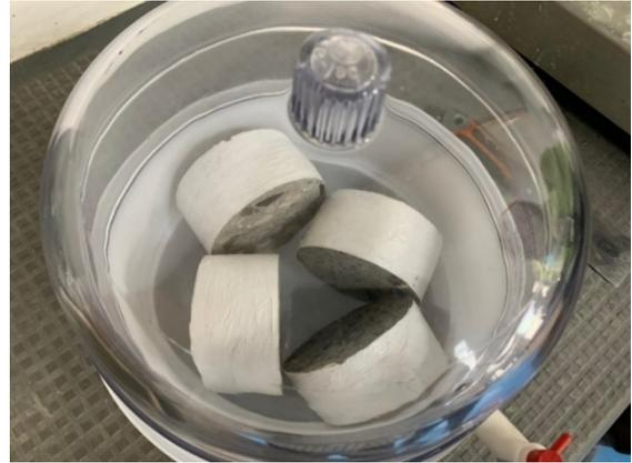
4. Verificar que el anillo de goma se encuentre en la olla de vacío. Colocar vaselina en la junta de la olla de vacío y su tapa para conseguir un cierre hermético. Cerrar la olla de vacío con las probetas en el interior. Conectar la bomba de succión a la olla de vacío. Enchufar y encender la bomba. Subir lentamente la potencia de la olla hasta llegar a los 30 bares. Esperar 5 horas a que las probetas queden al vacío.
