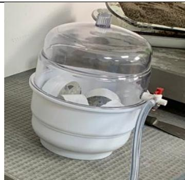
**Figura 2.20** Olla de vacío
