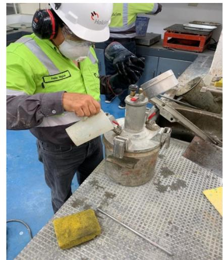
15. Bombear aire dentro de la cámara por medio de la tapa con el fin de encerrar el manómetro que se encuentra en la misma.
