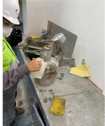
14. Verificar que esta cavidad este llena mediante la salida de agua de la otra válvula de purga de agua.
