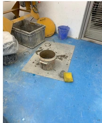
2. La superficie en la que se vaya a realizar el ensayo debe de estar nivelado y no debe presentar ningún tipo de vibraciones para no alterar el ensayo.
