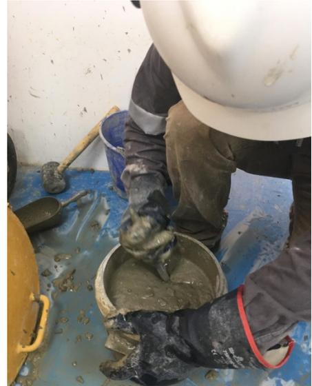
6. Impartir 15 golpes en la parte exterior del recipiente de ensayo utilizando el mazo de goma, esto con el fin de cerrar los huecos dejados por el proceso de varillado descrito en el paso anterior.
