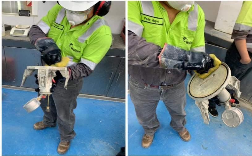
11. Colocar la tapa de manera centrada evitando que esta se manche con pasta de hormigón y cerrar en cruz las grapas sujetadoras.
