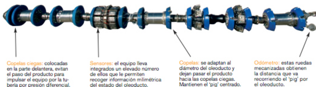
Figura 2.1: Equipo de inspección de tuberías, denominado “mandril”
