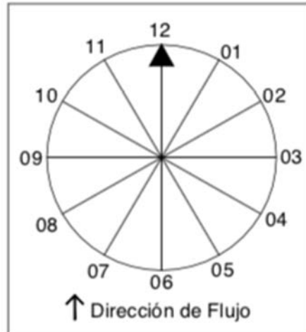
Figura 4.3: Uso de las manecillas del reloj para localizar fallas transversales.
