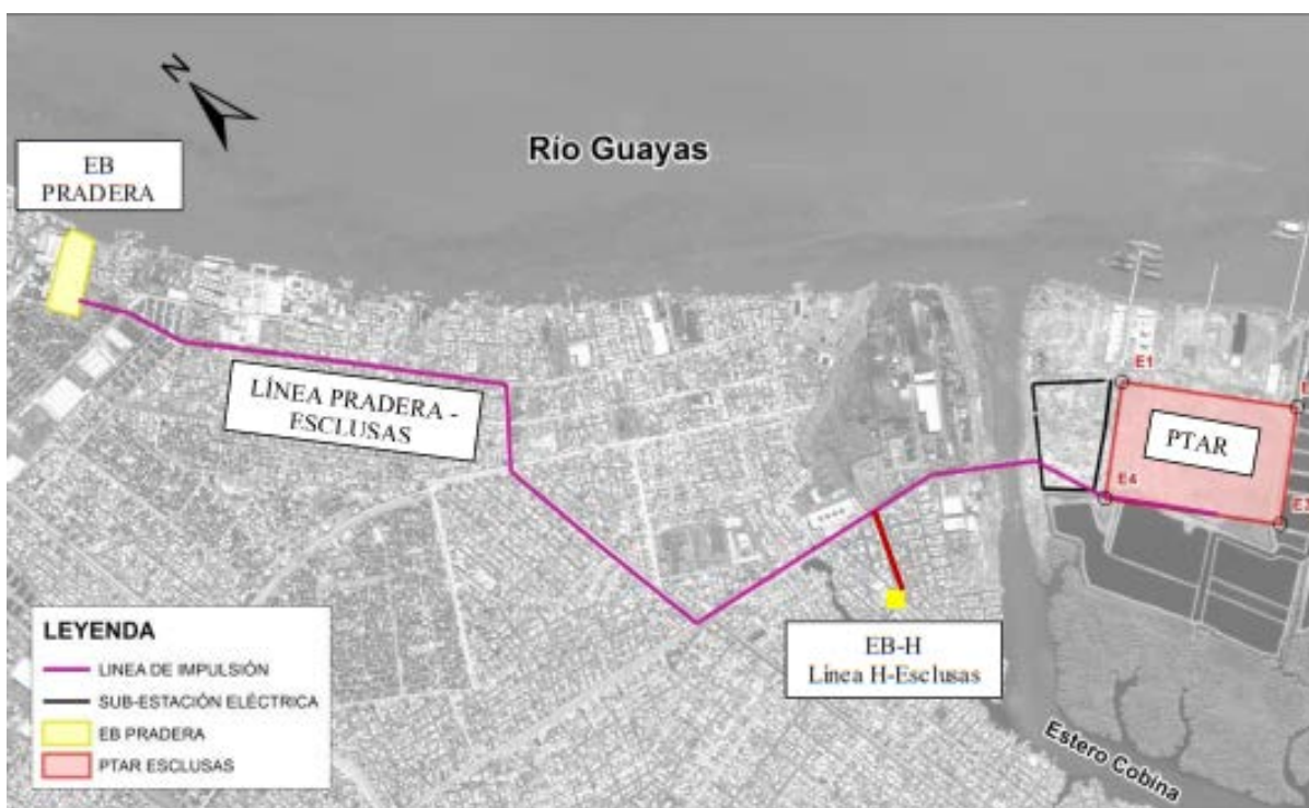
Figura 4.5: Línea de impulsión “Pradera -Las Esclusas”
