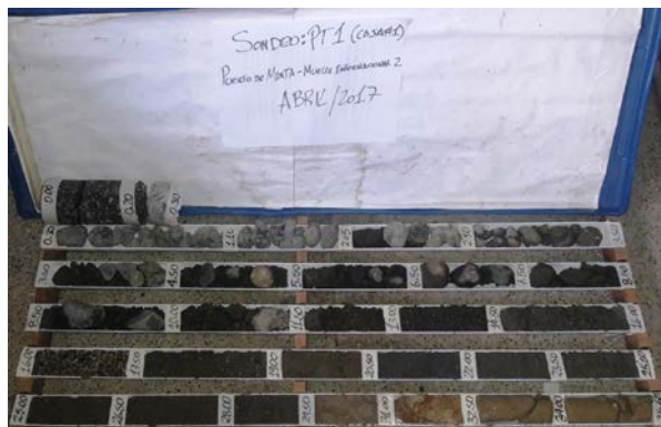
Muestras de suelo recuperado en las perforaciones PT1
