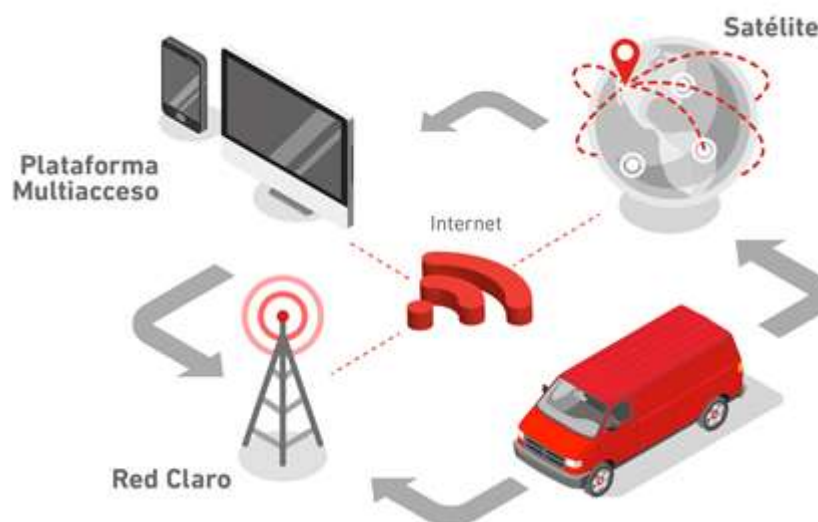
Figura 4 Esquema de Funcionamiento Dispositivo de Georreferenciación Fuente: CLARO
