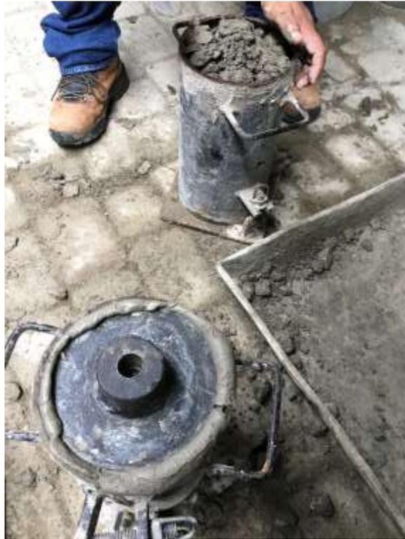
Ilustración 8: Anillo de mortero formado alrededor de la placa de apisonamiento.
