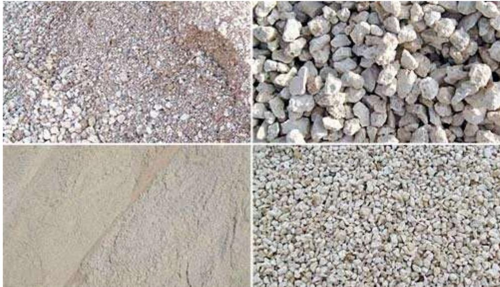
Ilustración 2: Agregados del hormigón
