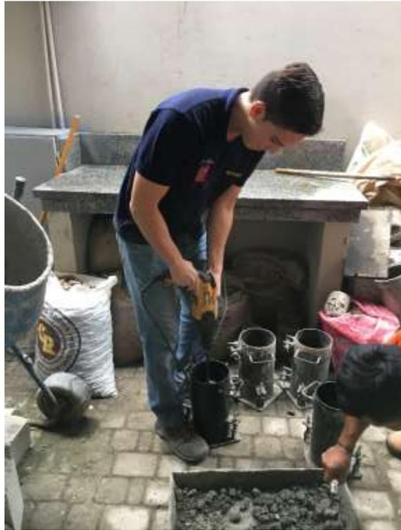
Ilustración 7: Muestra de hormigón siendo compactada en cilindro.
